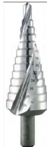
Para el taladrado de orificios cilíndricos en material con un espesor de hasta 6mm. Tanto el taladrado como el desbarbado se llevan a cabo en un solo paso de trabajo gracias al corte oblicuo del siguiente escalón. Para evitar la rebaba de material, utilizar pasta para taladrado.
