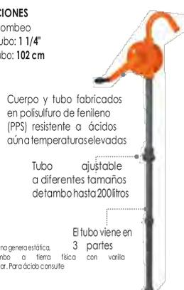
Nota: El uso con gasolina genera estática, conecte el tamboro a tierra física con varilla de cobre antes de usar. Para ácido consulte empaque.
